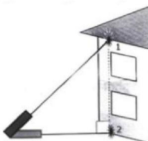
**Косвенное измерение (измерение катета).** Если для полного измерения высоты необходимо произвести два или три замера, можно воспользоваться функцией косвенного измерения.
